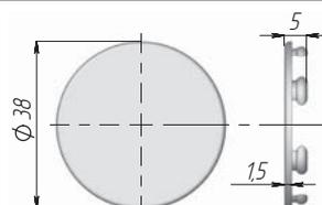
• **Примечание:** при использовании заглушки отверстие под эксцентрик сверлится на 4 мм глубже
