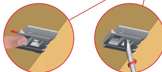
Для снятия полки достаточно перевести защелку в открытое положение вручную или с помощью отвертки
