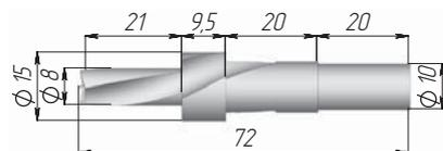
• **Материал:** металлический сверхтвердый сплав, который является разновидностью «быстрорежущей стали» и является одним из наиболее прочных материалов на рынке, используемый для изготовления вращающихся головок сверл
