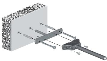
TRIADE крепится к кронштейну при помощи винтов M5x12 мм.
