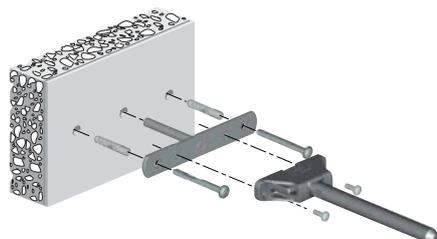
TRIADE MINI крепится к кронштейну при помощи винтов М5х12 мм.
