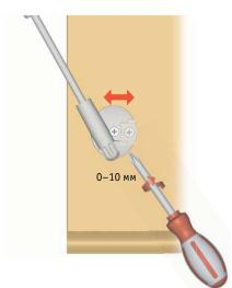
Открывание и закрывание двери может быть отрегулировано позицией лифта в креплении к боковине:
